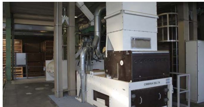
En langsoldsmaskine, der hjælper med at finrense væselhale fra rødsvingel
