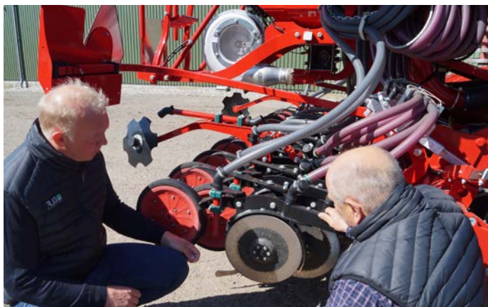
Den nye Horsch Pronto med præcisionsudstyr. Udlægget sås nøjagtig i den ønskede dybde, gødningen placeres under sårækken og trykrullen følger efter, så frøet trykkes godt til underlaget
