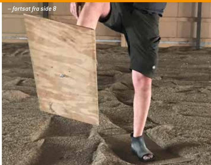
Sikke nogle plader! Hjemmekonstruerede frøsko til brug i frøtørreriet, så frøet ikke komprimeres
