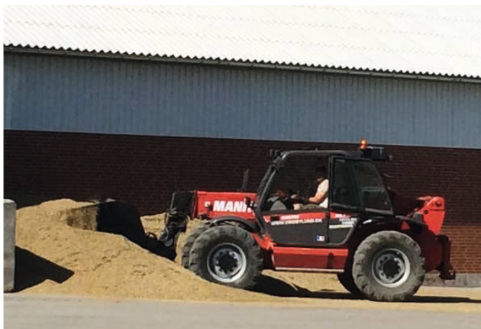
Teleskoplæsseren gør arbejdet med at flytte frøet ind og ud af det kørefaste tørreri
