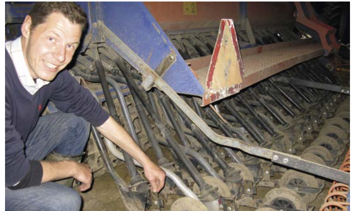
Øverst ses Søren med den hjemmebyggede Nordsten, med trykruller, der styrer sådybden. Denne såmaskine sår kornet. Nederst ses den anden Nordsten der bruges til frøudlæg. Bemærk spredepladen på de forreste såtrage
