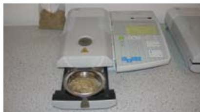
Vandmålingsapparat til måling af vandindhold i græsfrø.
