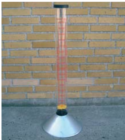
Flowmeter til måling af luftgennemstrømning i frøet
